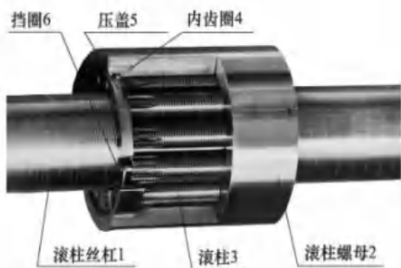
图 32：行星滚柱丝杠构成
