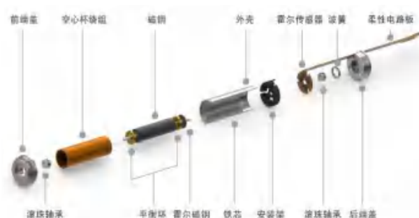
图 25：（无刷）空心杯电机结构
