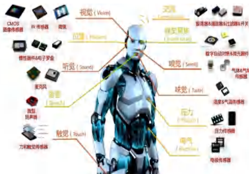
图 14：人形机器人传感器应用位置示意图
